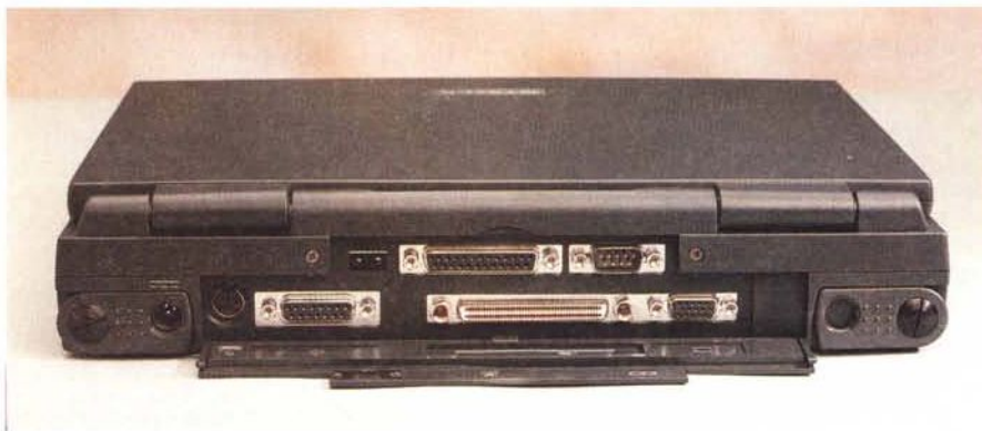
Un ampio sportello copre tutte le porte disponibili per il collegamento con il mondo esterno, ma si può fare a meno di aprirlo. Infatti quasi al centro c'è una finestrella per la porta a raggi infrarossi a standard IRDA (corrispondente alla COM2), per il collegamento con altrettante periferiche che possono dialogare con tale sistema.
